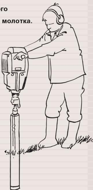
С помощью цилиндрического бура Вы можете отбирать почву с сохранением ее структуры на глубине до 1 м. Это позволяет быстро получить описание почвенного профиля, корневой системы и т.д. Широко применяется в с/х.
