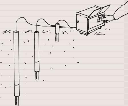
Датчик в профильном исполнении устанавливают в тонкостенную трубку, показания снимают измерителем.
