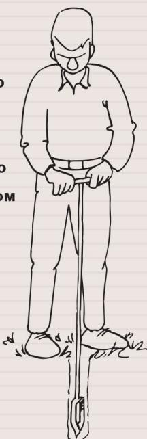
Пенетрометр используется для измерения сопротивления почвы проникновению.
