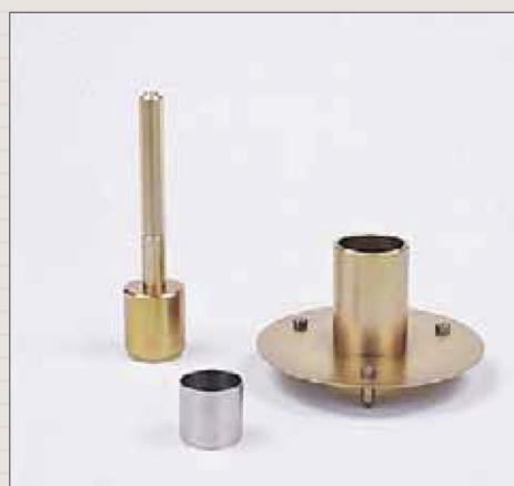
Устройство для забивания кольца и направляющий цилиндр
