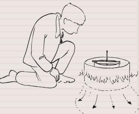
Измерение степени проникновения воды в почву широко используется в с/х при определении эффективности ирригационных, дренажных систем.
