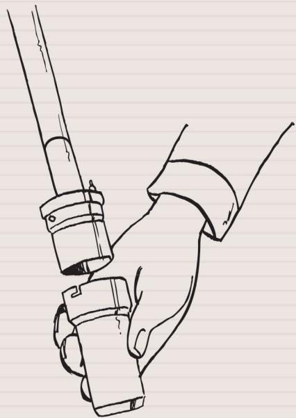
Устройство для забивания кольца и направляющий цилиндр.
