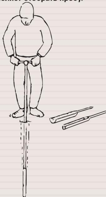
С помощью уловителя камней камень извлекается из скважины.
