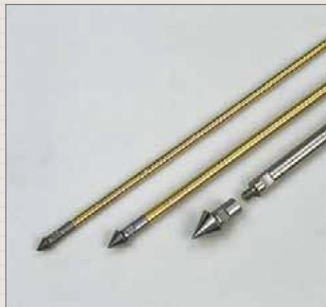
Конусы и устройство для зондирования почвы
