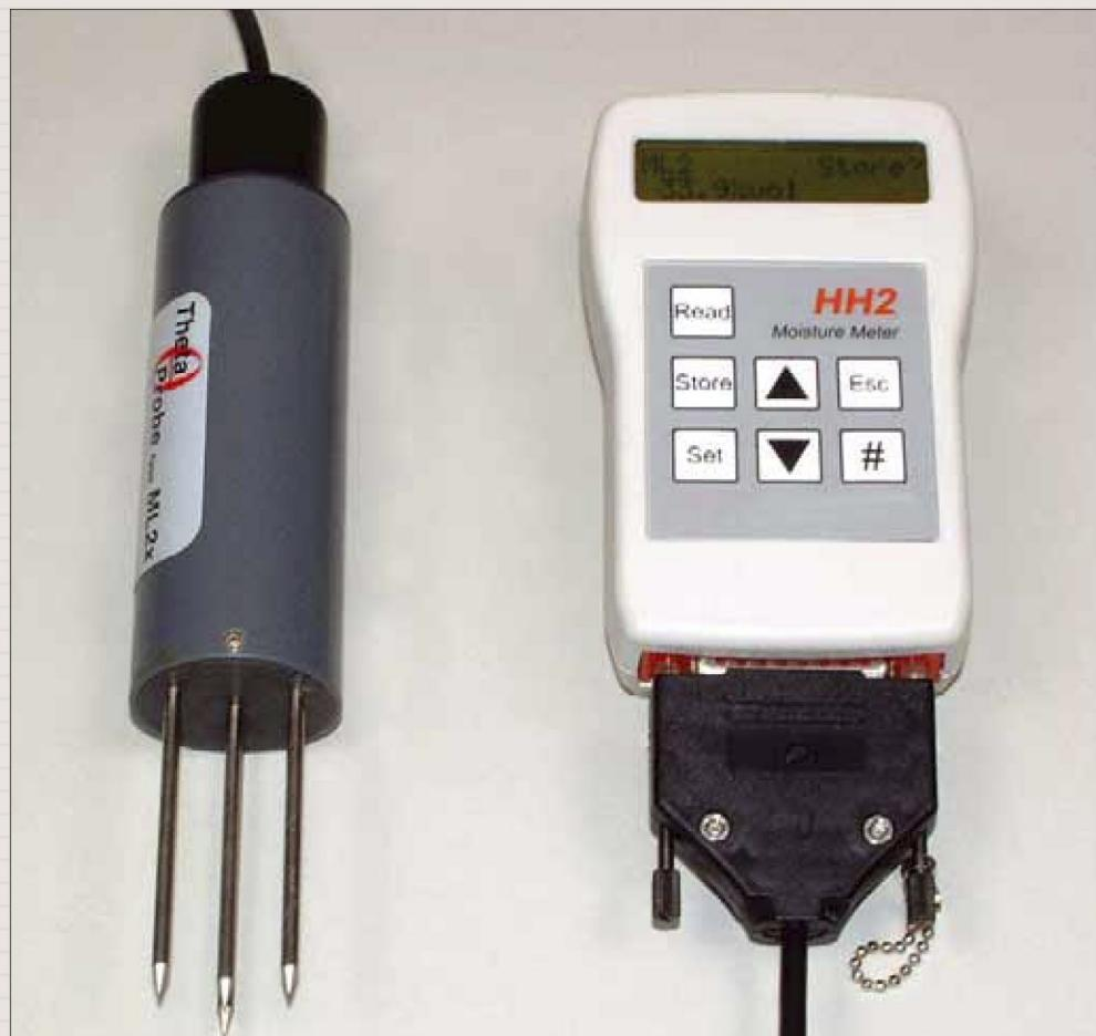
Измеритель влажности с датчиком влажности Thetaprobe
