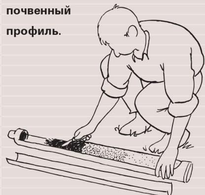
**После отсоединения головки с применением ручного бура, она извлекается с помощью специального стального крюка.**
