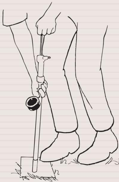
**Отверстие для тензиометра готовят с помощью бура.**
