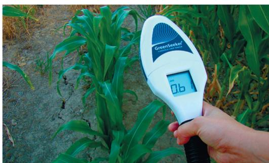
Для обеспечения достоверной информации при измерении прибор держится на расстоянии **60-120 см** от растения
