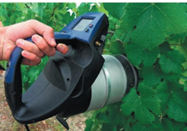
Устройство способно охватить поверхность площадью до 50 см<sup>2</sup> (это равносильно величине листовой пластины или целому плоду)
