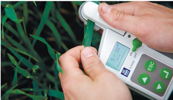
Измерения сильно зависят от различных культур и стадии роста. По этой причине измерения прибора должны быть откалиброваны!
