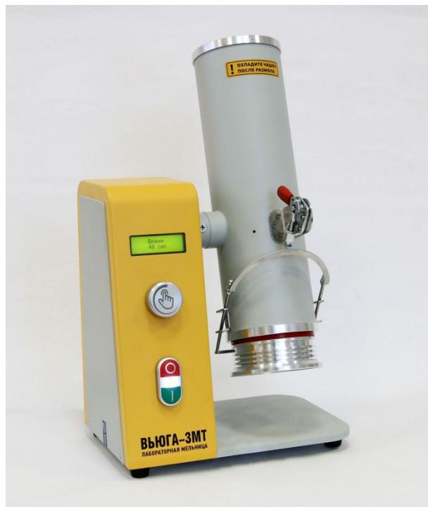
**Рис. 3.** Положение размольного узла при загрузке и выгрузке проб
