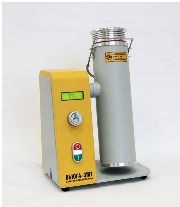
**Рис. 4.** Положение размольного узла при размоле проб (рабочее положение)
